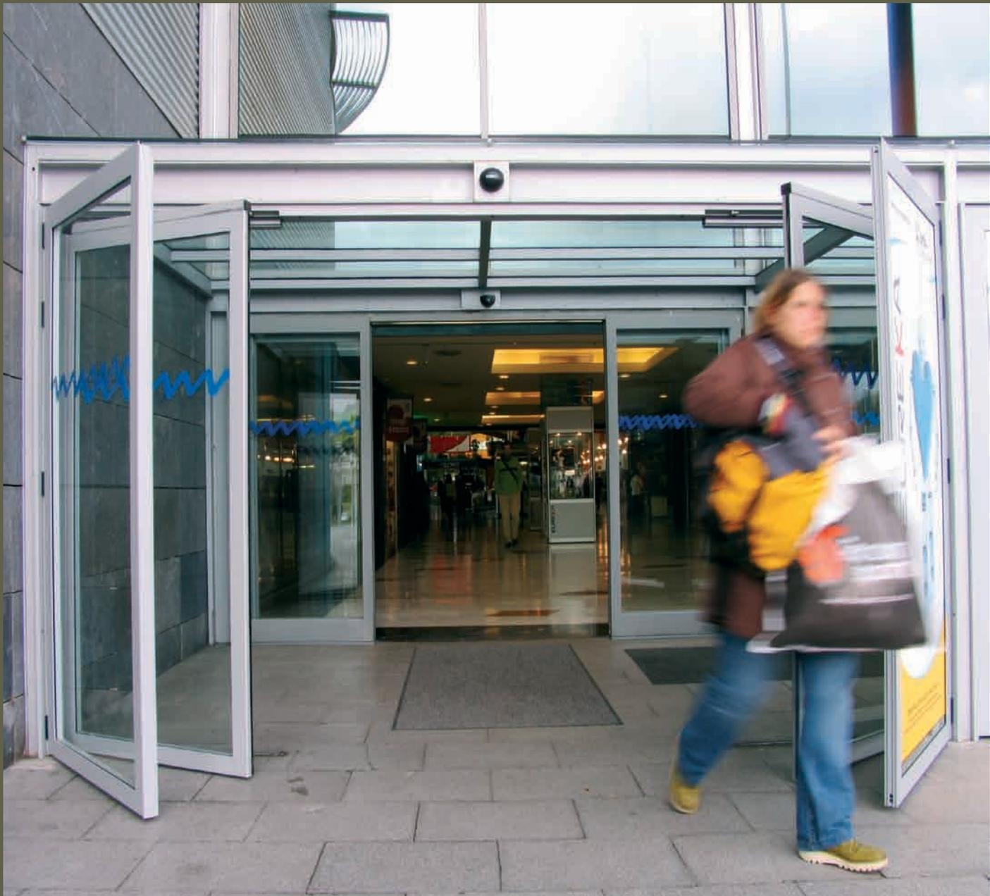
El sistema **ANTIPÁNICO** de empuje permite, mediante la transformación de la puerta corredera en batiente, la máxima apertura posible para permitir el paso libre de los peatones en caso de emergencia.
