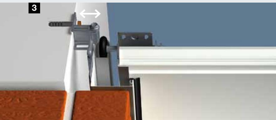
**3** Montaje en fachadas no portantes (ladrillos sin revestir o aislamiento térmico) con un anclaje lateral de mín. 90 mm / máx. 125 mm
